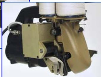
Die **Klassen 2200AB, BB** werden zum Verschließen mit aufgenähtem Reiterband eingesetzt. Sie sind mit Bandeinfassapparat und elektromagnetisch betätigtem Bandabschneider ausgestattet.
